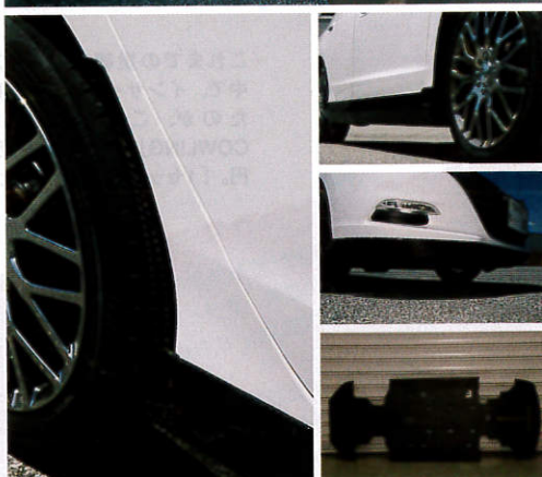
フロントのチン部分からサイドスカートまでカバーするアンダーカウル。重量的には25kgほどになってしまい、これからこの分の軽量化をしていくという。リアタイヤのホイールアーチ前方に取り付けられてるでっばりはレーシングカーにも使われている空力パーツのひとつ
