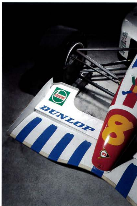
レイナードのハイノーズに対してローノーズを採用。ノーズコーン下面の形状と合わせ、コンベンショナルななかにも革新性を模索した。
