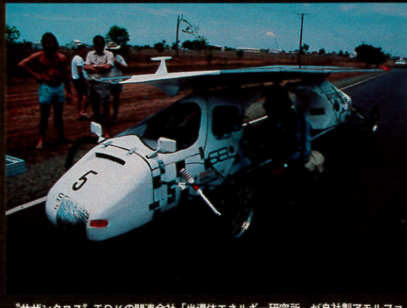
「サザンクロス」TDKの関連会社「半導体エネルギー研究所」が自社製アモルファス太陽電池のデモに出場。バッテリーは最少容量なので11月11日現在1000kmを走破
