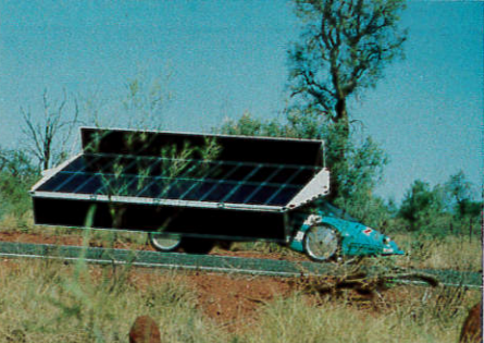
「ソーラー・ジャパン」のソーラーセルは直射光に高効率のシリコン単結晶セルと拡散光に高効率のアモルファスセルを併用している。 鐘淵化学工業の浅岡圭三さんは我が子のようにセルの機嫌をうかがう
