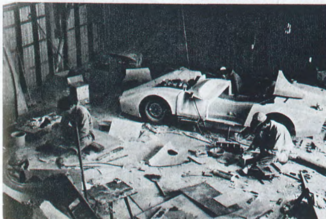
できあがったボディ各部は部分修正をへながら組み立てが進められる。
