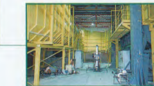
四角く回流する風管の中央から、空気の流れを整えつつ集めて測定部に流し込む「縮流部」を見る。絞り込みがかなりきつい。縮流比を大きくとってあるのは、測定部を吹き抜けてゆく空気を一様かつ安定した流れにして、測定精度を上げたい、という意図による。
