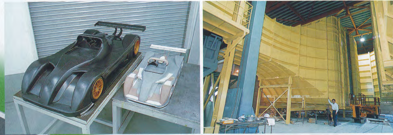
25%モデルと50%モデルを比較する。細かいディテールを作り込むことで、50%風洞では実戦的なデータを収集することができるのだ。
