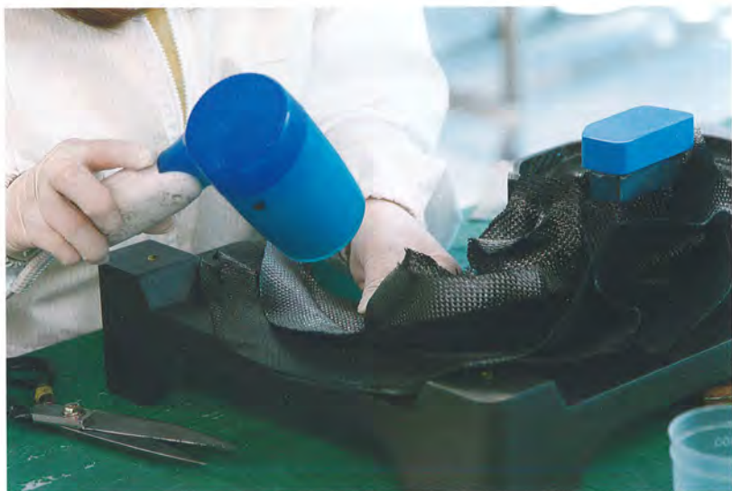
裁断したCF織物を型に貼り込む作業。ドライヤーで部分的に温めながら、その温め方を調節しながら、設計図面どおりに貼ってゆく。量産しなければならない製品は、このように型もカーボンでつくられる。
