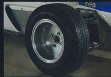
キレイに再生されたフロント・ホイール。タイヤはダンロップ・レーシングCR65でサイズは前後とも5.00/L-10。
