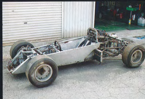
ご覧のようにパニックのスペースフレームはボクシング・タイプの高さを強くに組まれている。黎明期のJ500にあつては、かなり本格的なものといえた。
