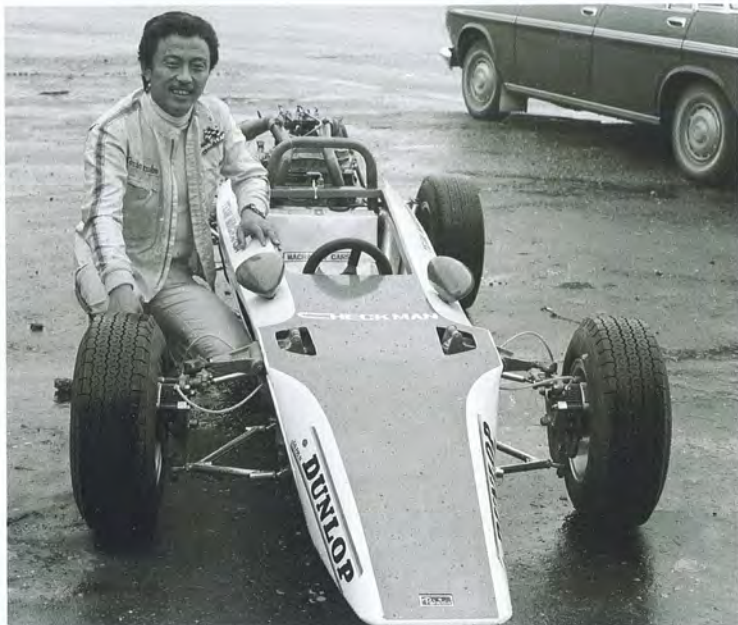
MACRANSA PANIC 1971.8.22 SUZUKA GREAT20 DRIVERS RACE マクランサ・カーズ名義で発表された最後の作品。1970年より正式に施行されたFJ360/500規定にあわせ開発されたフォーミュラ・ジュニア。エンジンはN360をベースとしたヨシムラ・チューンの500ccユニット。写真はレースの当日、プラクティスの出走前と思われる1枚で、クルマの左側に座るのは元チーム・トヨタの大坪善男。
