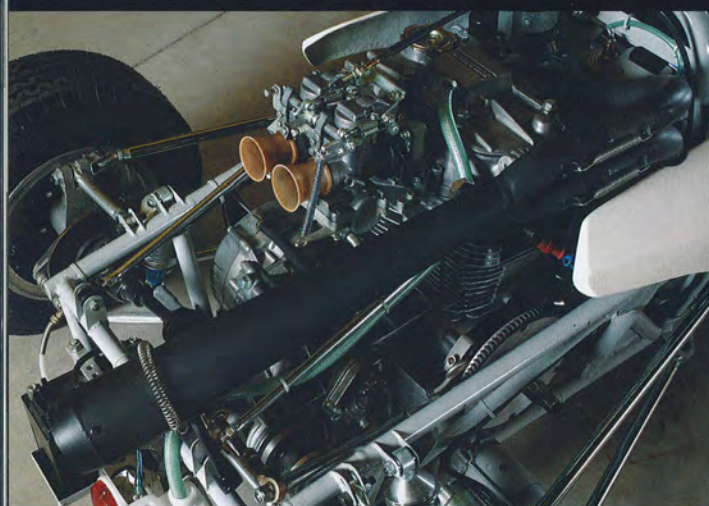
当初搭載されていたホンダ・エンジンの500cc、決勝で使用したイマルの360ccエンジンは失われていたため、当時のホリア・アブ・キートとこれまた貴重な当時モノのCRキャブが組み込んだN360のエンジンが搭載された。ヘッドはブルーボルト・エクソースト・パイプは当初装着されていたという1本出し仕様を再現。
