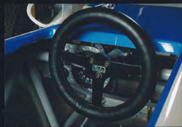
林氏自製のステアリングも見事にレストアされ、センターには“Panic”のセンターマークも新たに追加された。メーター、スターターもオリジナルをリペアしたもの。
