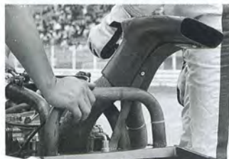
現在は失われてしまっているが、当時、予選/決勝時にはこのようなインダクション・ボットが装着されていた。当時のフォーミュラカーとしては珍しい、最新の装備だった。
