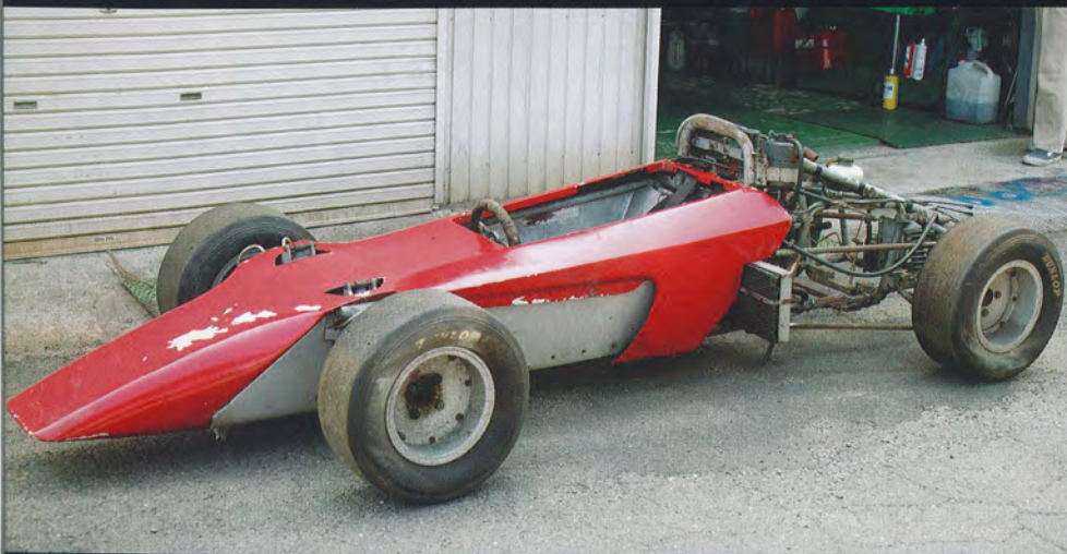
発掘直後のパニック。カウルが赤にリペイントされ、サイドにラジエーターが追加されている以外、ほぼオリジナルのコンディションを維持している。
