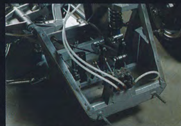
マスターシリンダーはすでに欠品だったため、3個ともオリジナルを丹念にO/Hした。ちなみに前2、後1の配分となっている。
