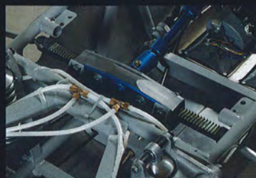
特徴的なストレート・カットのラックをもつ、ラック&ピニオンもオーバーホールして使用。このようにほぼ全てのパーツが再生して使用された。
