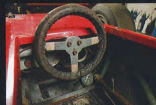
油温系が追加されていた以外、林氏自作によるステアリングなど、装備品はすべてオリジナルのまま。ステアリング左奥に見える赤いボタンはスターター。
