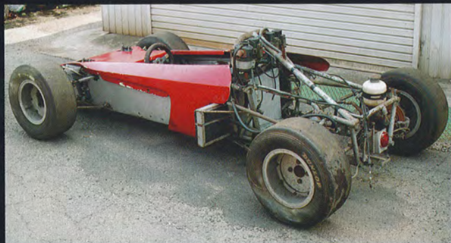
本来搭載されていたはずのN360のエンジンが外されているほか、ロールオーバーリア・フレームに向け、1本パイプが追加されているのがわかる。
