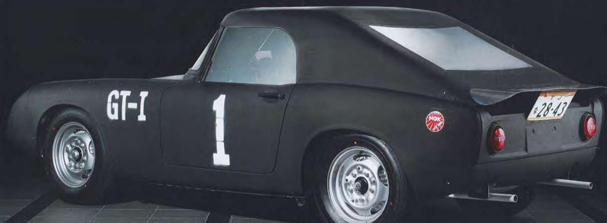
可能な限りスムーズな空気流の中を進む、ファストバック形状のハードトップとしたのはこうした発想によるものだ。千葉ナンバーは車両が浮谷(市川市在住)のものである証し。
