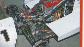
エンジンはプレリウド用の2.2 DOHC VTEC
