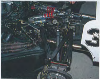
横置きギヤボックスは日本の柳河精機製だ
