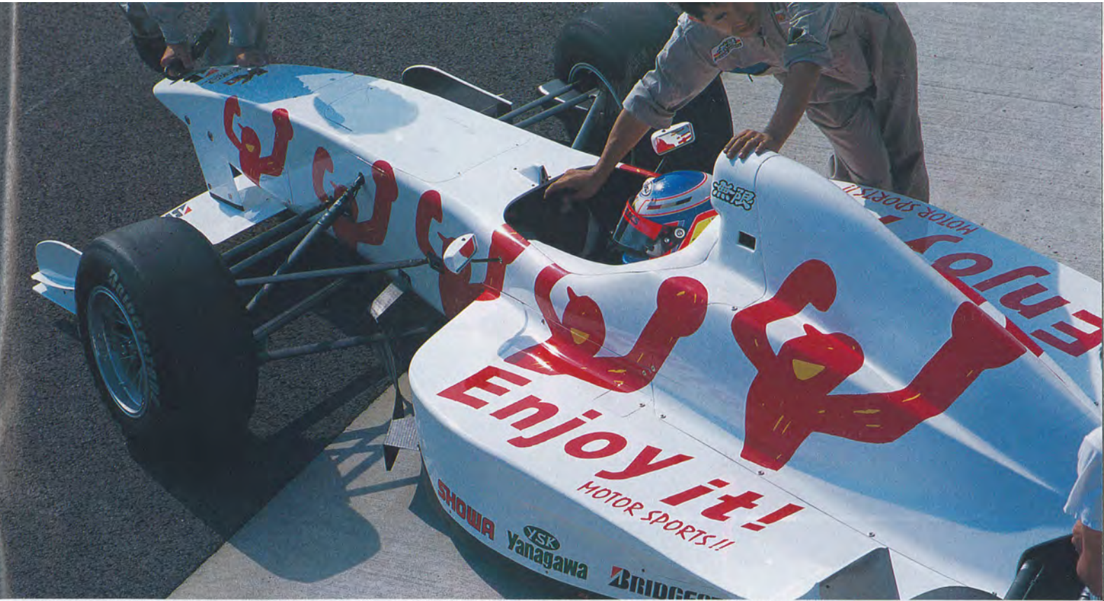
F1規定に合わせて設計されたカーボンコンポジット構造のモノコックは、オーバル走行に備えて強度が十分に高められているという。ボディはホンダの「Enjoy it!」カラーだ
