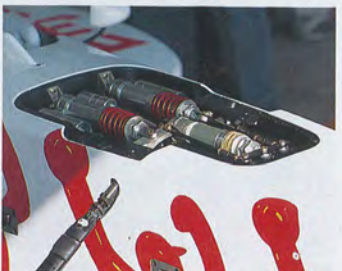
フロントにはサードダンパーも装着される
