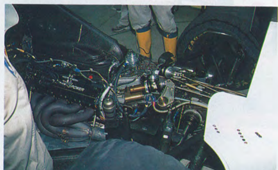
新たにサーボバルブ式に変更したセミAT、フライバイワイヤーも採用している
