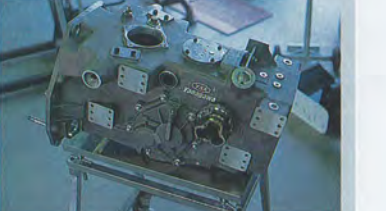
こちらはSRS-F用の柳河精機製ギヤボックス
