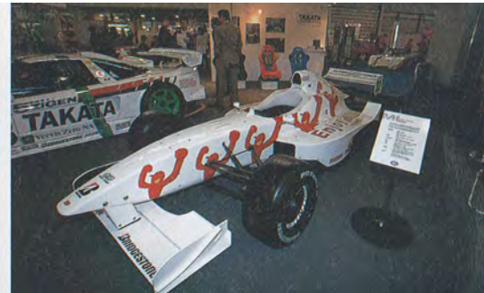
ホンダの要請によって開発されたプロトタイプフォーミュラ、ML(もてぎライツ)。オーバルを念頭にしているが、F1仕様のモノコックやエアジャッキ装備など注目点多数
