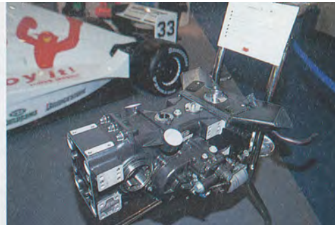
MLに搭載されている柳河精機製の縦置きトランスミッション単体も展示された。このミッションへの注目度も高かったようで、童夢のスタッフに「例えばこんなミッションは作れるのか?」との質問が多数寄せられた
