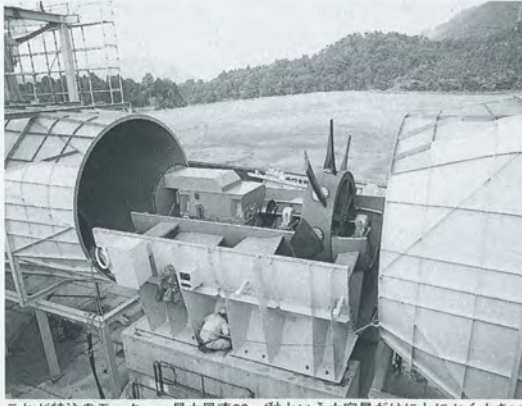
これが特注のモーター。最大風速60m/秒という大容量だけにとにかく大きい
