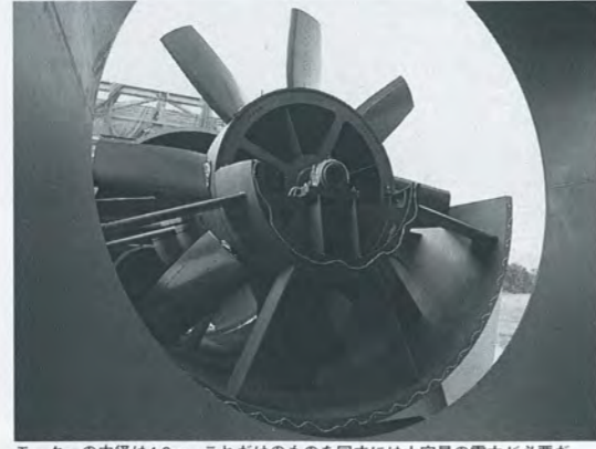
モーターの内径は4.3m、これだけのものを回すには大容量の電力が必要だ
