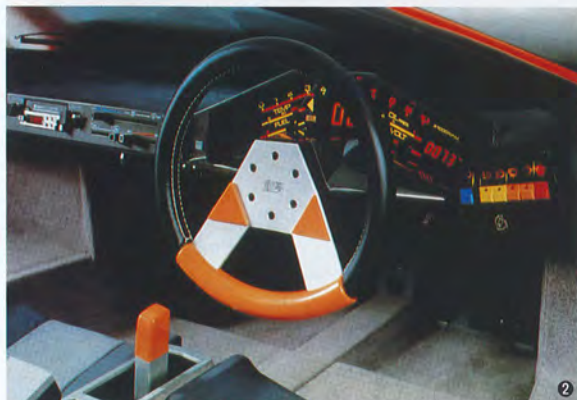
①シートも外観に合わせた直線基調でデザインされている。また広いサイドシルにはオーディオのスピーカーの他に灰皿までが備わる。 ②クルマの情報は全て正面のデジタル・ディスプレイに表示される。ライトやワイパーの操作は右のカラフルなスイッチで。ちなみにウインカーは右手で空を切ると、センサーが反応し点灯するといった高度な技術が使われていた。 ③特徴的なシフトレバー。その後ろにあるのはサイドブレーキのレバーである。 ④レーシングカーのような造りのABCペダル。いずれもストロークが短く、ソリッドな感触。
