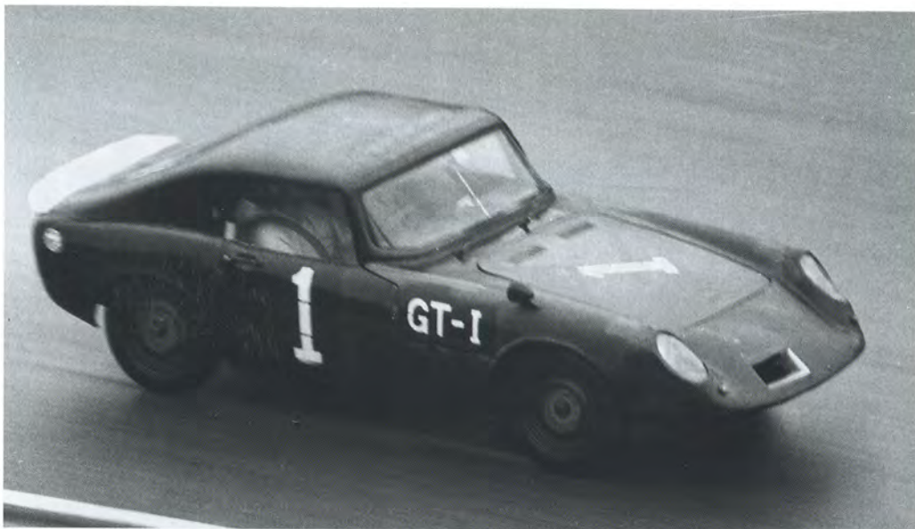
マシンデザイナー林みのるの最初の作品カラス。ホンダS600をFRP製のノーズコーンとファストバック・ハードトップで改造する。若干の軽量化をほどこされているがボディモディファイの目的は空気抵抗の減少にある。GT1クラスでデビューウインをなし遂げた。
