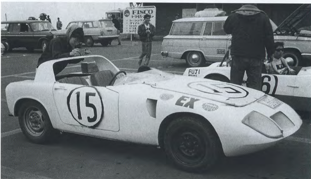
Tojiro II。ホンダS600改カラスをベースにしてさらに軽量化と空気抵抗減少をほどこされたオープン2シーターである。林みのるの作品のなかでは唯一のアルミボディをもつマシンだ。1966年日本グランプリのエキシビジョン・フォーミュラレースに出走した。
