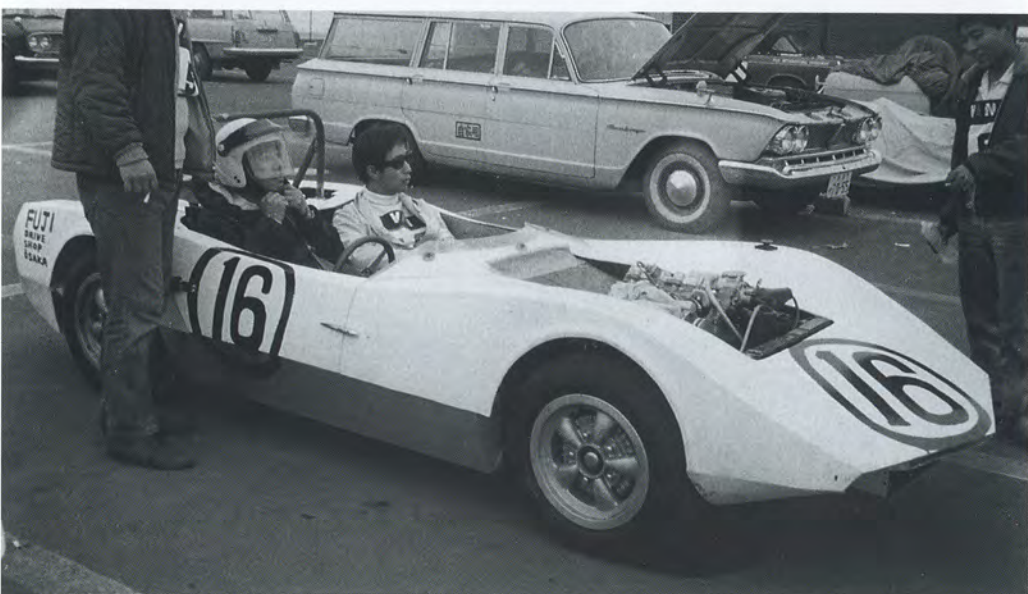
関西スポーツカークラブの矢吹圭造のオーダーによって製作されたTojiro III。ホンダS800ベースのオープン2シーターである。1966年日本グランプリのエキシビジョン・フォーミュラレースに出走するが、スーパーチャージャーのトラブルで実力発揮ができなかった。
