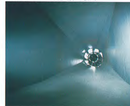
風路の内側から送風機を見る。手前に見える羽根はカーボン製の静翼で、整流板の役割を果たす。抵抗を発生させないため、風路は滑らかに広がる
