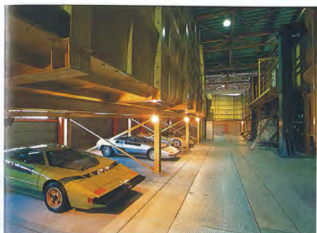
風流舎内部の様子。巨大な風路が横たわり、回流式の風洞であることがよく分かる。その下には童夢「零」など歴代のマシンが並ぶ
