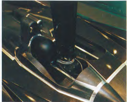
この支柱でモデルを上から下げる形をとる風流舎。ちょうどコックピットとの接続部分に六分力天秤が内蔵されている
