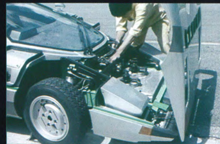
テスト当初は冷却に悩まされたというが、この映像ではラジエーター上にシュラウドが付けられているのが確認できる。
