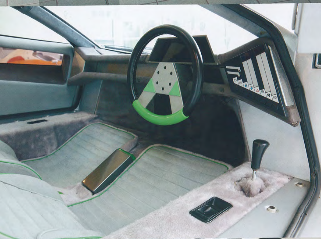
① 零のリアビュー。テールランプなども流用ではなくスタンレー製のワンオフ品を使用するなど、細部に至るまで拘りが買われている。② ヘッドレスト一体型のシート。手前に見えるのはエアコンのコントロールユニット。エアコンユニット自体は右サイドインテークの背後に収納され、リアバルクヘッドに吹き出し口が付く。③ あまり公開される機会のないエンジンルーム。当時の写真のとおり、サブフレームがグリーンに塗装されている。3基のツインチョーク・ウェーバーが付くL28ユニット。フルシンクロの5段ギアボックスはZF製のSDS-25/2型。④ モダンなコクピット。ライトなどのスイッチは右に集約された操作パネルに収まる。シート間にあるのはサイドブレーキ。右のシフトレバーは発表当初は緑の筒状のものが付いていた。⑤ タイヤはフロント185/60VR13、リア255/55VR14と前後異径サイズ。ブレーキはフロントがガーリング製AR5ベンチレーテッドディスク。リアはインボード式のARGソリッドディスクが装着された。ホイールもオリジナルデザイン。⑥ フロントフードを開けると、2基の電動ファンが付いた大型ラジエーターが姿を現す。
