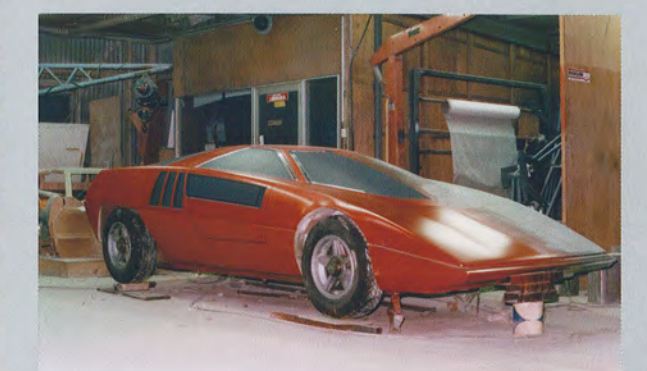
童夢の秘蔵アーカイブから。開発作業が行われていたハヤシレーシングで撮影されたと思われる原寸大のクレイモデル。最初から基本となるデザインシェイプは変わっていない。
