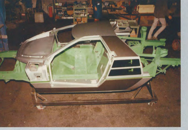
前後サブフレームをもつスチール製のセンターモノコックにFRPのセミモノコックボディを組み合わせたシャシー。完成後見えなくなる細部もしっかり「デザイン」されていた。
