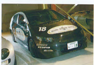
2010 ECOL DOME SUPER INSIGHT 童夢のノウハウを生かし空力の改善と軽量化で、市販型比 20% の燃費向上を目指した試作車。エコカーカップ 2011 Hybrid 日本一決定戦など、様々なエコカーレースで優勝している。
