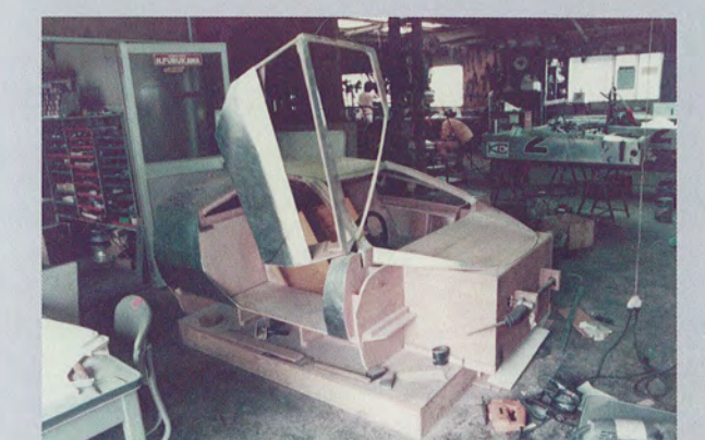
ハヤシレーシング監で作業が進められる原寸大のモックアップ。ガルウインドアやステアリングラックが装着されているのに注目。1977年頃の撮影。奥にFLマシンが見える。
