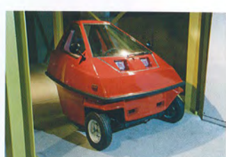
1981 TOMITA AUTO COMET トミタオート (当時) の依頼で開発された原付免許で運転できるシティコミューター。基本コンポーネントはホンダ・タクトのものを流用。10 数台が製造されたが、免許制度の変更で姿を消した。
