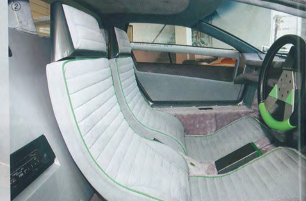
① 零のリアビュー。テールランプなども流用ではなくスタンレー製のワンオフ品を使用するなど、細部に至るまで拘りが買われている。② ヘッドレスト一体型のシート。手前に見えるのはエアコンのコントロールユニット。エアコンユニット自体は右サイドインテークの背後に収納され、リアバルクヘッドに吹き出し口が付く。③ あまり公開される機会のないエンジンルーム。当時の写真のとおり、サブフレームがグリーンに塗装されている。3基のツインチョーク・ウェーバーが付くL28ユニット。フルシンクロの5段ギアボックスはZF製のSDS-25/2型。④ モダンなコクピット。ライトなどのスイッチは右に集約された操作パネルに収まる。シート間にあるのはサイドブレーキ。右のシフトレバーは発表当初は緑の筒状のものが付いていた。⑤ タイヤはフロント185/60VR13、リア255/55VR14と前後異径サイズ。ブレーキはフロントがガーリング製AR5ベンチレーテッドディスク。リアはインボード式のARGソリッドディスクが装着された。ホイールもオリジナルデザイン。⑥ フロントフードを開けると、2基の電動ファンが付いた大型ラジエーターが姿を現す。
