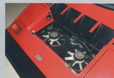
零ではフロントフードが大きく開いたが、P-2 ではラジエーター上部のパネルが開くだけに変更されている。零ではオーバーヒートに悩まされたため、P-2 では最初から電動ファン付きの大型ラジエーターが採用された。
