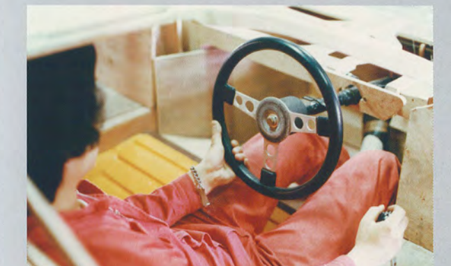
モックアップを使いドライビングポジションの検討をしているショット。全高1m以下で室内がタイトなのにも関わらず、零の運転環境が歪んでいないのはこれらの成果といえる。
