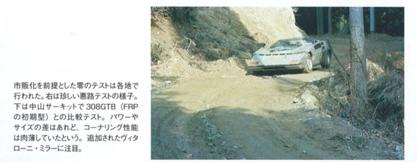
市販化を前提とした零のテストは各地で行われた。右は珍しい悪路テストの様子。下は中山サーキットで308GTB（FRPの初期型）との比較テスト。パワーやサイズの差はあれど、コーナリング性能は肉薄していたという。追加されたヴィトロニ・ミラーに注目。
