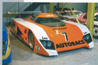
1983 DOME RC-83 ベンチュリーシステムを取り入れた国産グループ C マシンの祖といえる 1 台。T. ニーデル / E. エルグバ組が国内耐久選手権と 84 年のル・マンに出場。エンジンは DFL。
