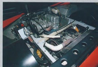
エンジンは 2.8ℓの日産 L28 ユニッド。当初はソレックスキャブを装着していたが、途中で日産 EGI インジェクションに変更 (現在はソレックス仕様)。トミタオート製のターボキットを装着し、テストしたこともあったという。
