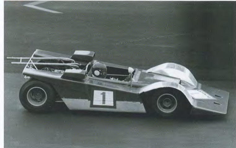
69年日本グランプリに向けて開発されたワンオフの車体。結局レースに間に合わず、田中慶治によって数レースに出場した。当時、一番金と手間がかかるのは原型の面出しだった。造形はウレタンでやるけど、それをメス型にするまでにすごい時間と費用がかかる。今みたいに社員がたくさんいるわけではなく、ほとんど数人でやっていたから、このあたりの省力化は大きな課題だった。クサビの時は、亡くなった浦池(蒲池)に手伝ってもらった。で、考えたのは、木型屋に造らせたサッシュにアクリル板を貼って、その面構成だけで造形する方法。だからあつという間に造ったよ。でも、結局出ようと思っていた69年のグランプリには間に合わなかったんだけど、その後、田中が買ってくれて借金を清算できた。当時のレギュレーションでは、ホイールセンターから上の180度のうちの1/3がカバーされていれば良いということになっていたから、クサビ形の板しかついていなかったけれど、その後、オーナーの田中が、(半円形の)フェンダーをつけ加えたんだと思う]
