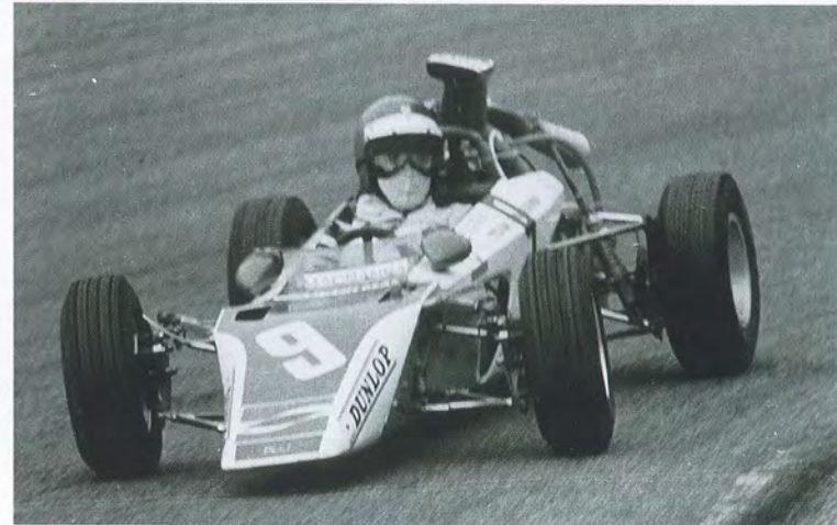
レグラッド社のサスペンションパーツを流用して造られたFJ。「当時は、工場も転々としていたから、もちろん、治具や定盤も持っていない。だから、苦肉の策として、パイプフレームのすべてのパイプを、ジグソーパズルのように、決められた場所にしか接合できないように設計した。そして端末を全部エンドミル加工し、太いH鋼の上に並べて溶接していった。つまり、治具や定盤も使わずにフレームを造る方法だった。それにまたアクリル板を曲げただけで造ったボディを架装した、いかに短時間で安く造るかという実験のようなマシンだった。よっぽど金に困っていたんだ。自分の置かれた環境を打破するための最後の悪あがきだったと思うが、このときも、やはり大金だけが残り、結局、レーシングカー造りを諦めるきっかけとなった。だからすぐに売却してしまったけれど、それが最近見つかったから買い戻してレストアした。しかし、レストアしたパニックを眺めると、あの頃の悲しい出来事がいっぱい思い出されて、ちょっとセンチな気分になったりするよ」
