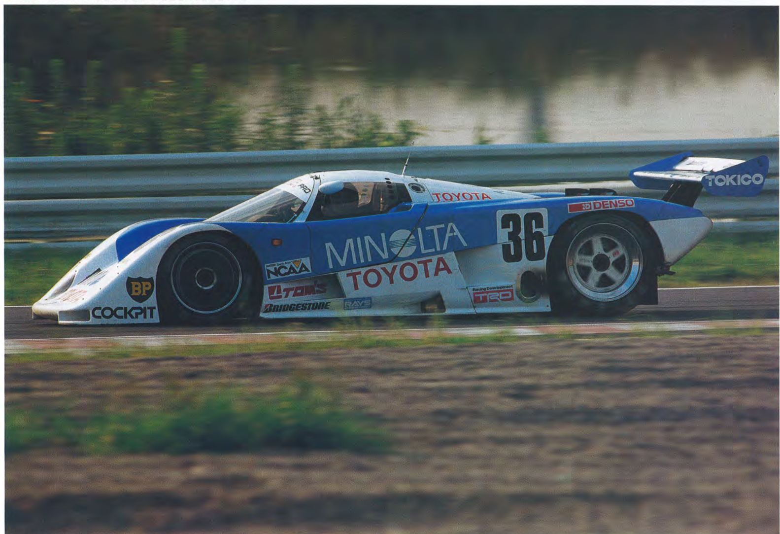
88Cは87Cの改良版。88C-VIはトヨタが新規開発したターボ過給V型8気筒エンジンを搭載したオールカーボンコンポジット製モノコックを持つ車輦。「トヨタのグループCカー開発の最後の頃、トヨタはトニー・サウスゲートをアドバイザーとして採用した。当然、サウスゲートは風洞試験の重要性を声高に言い出し、直ちに大きな風洞モデルを造ってインベリアルカレッジかどこかの風洞を使って実験を開始。いろいろ成果を引き出していった。当然「さすがトニー・サウスゲートだ」ということになるが、ずいぶん前から風洞を使って実験しなくちゃだめだと言いつつきたのに、スズメの涙ほどしか予算のもらえなかった我々は、サウスゲートの作らせた大型風洞試験モデルを眺めながらため息をついたものだ。反面、88C-VIに向けて、カーボンコンポジットの必要性もアピールしていたが、なぜかトヨタは、これにはとても熱心で、東しも巻き込んで、かなり高度な開発を支援してくれた。現在の童夢のカーボンコンポジット開発技術の礎はこのときに確立したといっても過言ではない。短期間に多くのことを学べる有意義な開発体験だった。しかし、ドライバーはまだフルカーボンコンポジットのシャシーが信頼し切れなくて「走るどころか割れる音がする」とか「プラスチックでできたシャシーなんて信頼できない」とか言っていたけど、実際にはまったく問題は起きなかった」
