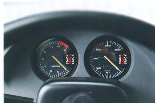
メーターナセルに収まるふたつのメーターはいずれもSTACK製のアナログで、速度計は320km/hスケール。回転計はなんと11000rpmからレッドゾーンが始まる。
