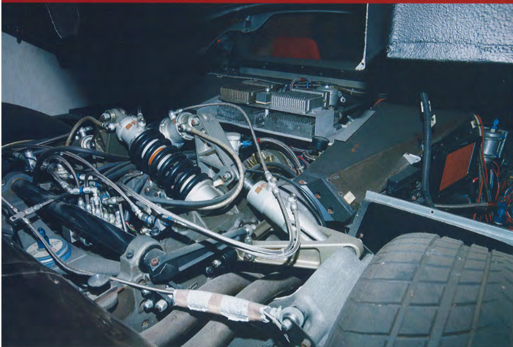
フロントまわりのレイアウトは、1号車、2号車ともにあまり変わりはない（モノコック自体は基本的に両者共通のもの）。ただ SHOWA 製の減衰力可変式ダンパーは、2号車が製作される約1年半のブランクの間にかかなり熟成されたといわれている。
