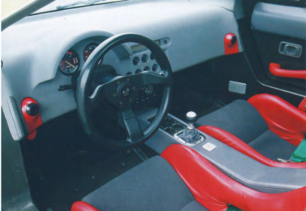
オリジナルの状態が良く保たれたコックピット。1号車(P94を参照)と比べると、細部がかなり変更されているが、基本構成は変わらない。ドライバーの足下付近に付くブレーキの前後調整レバーは、レーシングカー由来の成り立ちを感じさせる部分だ。
