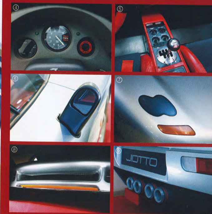
① 1号車のコックピット。P97のレンダリングをほぼ踏襲する形でデザインされているのがわかる。ステアリングは1号車専用のオリジナルデザイン。伊藤邦久によるとステアリングのラインに合わせたメーターナセルのデザインは、初代アウディTTでフリーマン・トマスが真似たと、後々告白したという。② レカロ製のバケットシートには、「CASPITA」の文字とロゴが入る。③ RAYS製のアルミホイールは鋳造ではなく鍛造。タイヤはキャスビタ専用で造られた日本ダンロップのSP SPORT D40 M2を履く。④ STACK製の回転計は12000rpmスケール。スピードは左のデジタルメーターに表示される。⑤ 6速シフトはフェラーリのようなゲート付き。⑥ 可動式ドアミラーを裏側から見る。⑦ 1号車の特徴でもある2灯のプロジェクトランプ。⑧ ノーズ下に付く可動式スポイラー。そのアイデアソースは童夢86Cで採用された手動式スポイラーだといふ。⑨ マフラーは4本出し。
