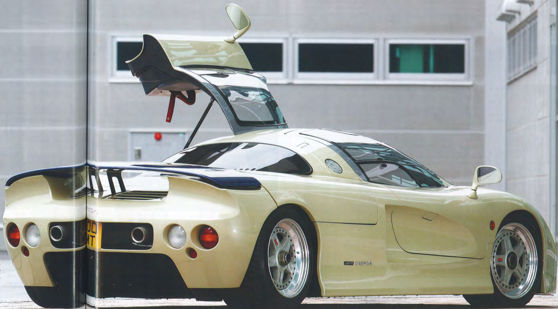
キャスピタ2号車のリアビュー。1989年にその基本デザインが完成していたとは思えないほど斬新で美しいデザインだ。リアに備わる巨大なウイングは油圧式で、190mmリフトアップする。
