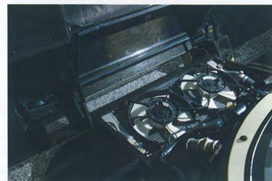
フロントカウルを開けると、2基の電動ファンをもつラジエーターが見える。エンジンルームの写真と併せてご覧いただくとお分かりのように、ラゲッジスペースは存在しない。
