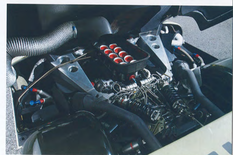
エンジンは585psにチューニングされた72度V10のジャッドGVユニットを搭載する。その変更に合わせて1号車ではインタークーラーのダクトを兼ねていたカーボン製のサブフレームが、2号車ではアルミになるなど、コストや生産性を意識した変更も行われている。
