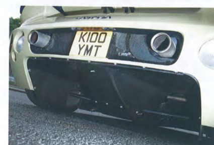
ベンチュリー効果を狙ったアンダーフロアは、幅の狭いジャッドV10の採用で改善された部分のひとつ。リアに残るナンバープレートは英国でテストしていた時代に取得したものの。
