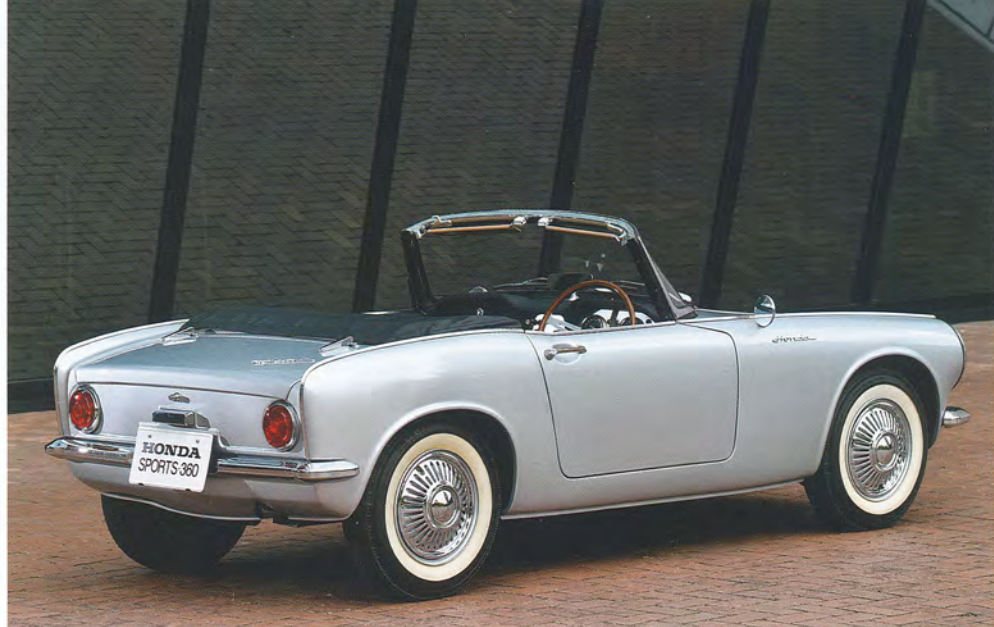
極限まで切り詰めたテールと、全幅の絶対的な狭さが、全長3m×全幅1.3mの軽自動車規格に縛られていることを物語っている。ただし基本的には伸びやかなシルエットを基調とするグッドデザインだ。
